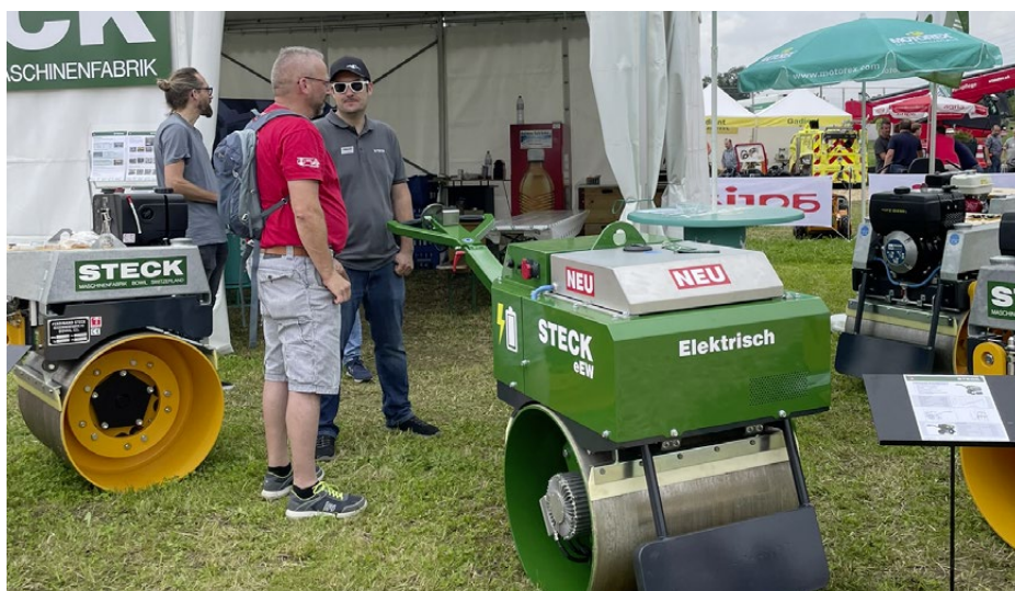
Testreifer Prototyp: eine vollelektrische, 620 Kilogramm schwere Einrollen-Vibrationswalze mit Wechselbatterie vom Hersteller Steck.
