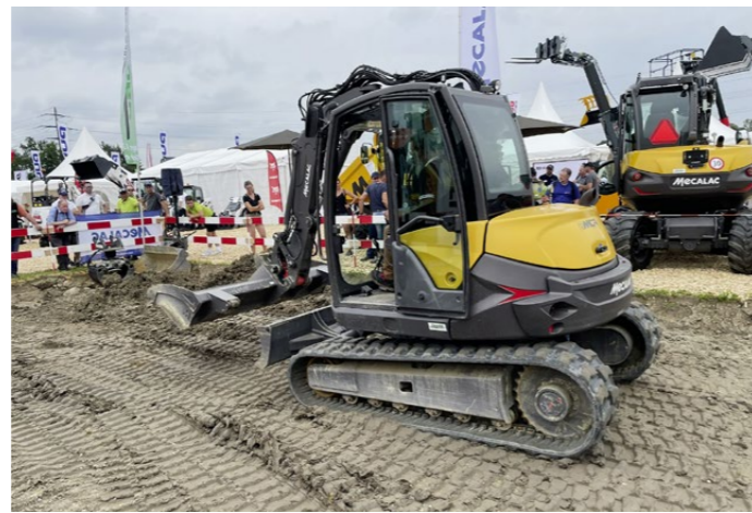
Gewohnt vielseitig: Spezialmaschinen von Mecalac (Aggeler) können sich sekundenschnell von einem Bagger in einen Lader und zurück verwandeln.
