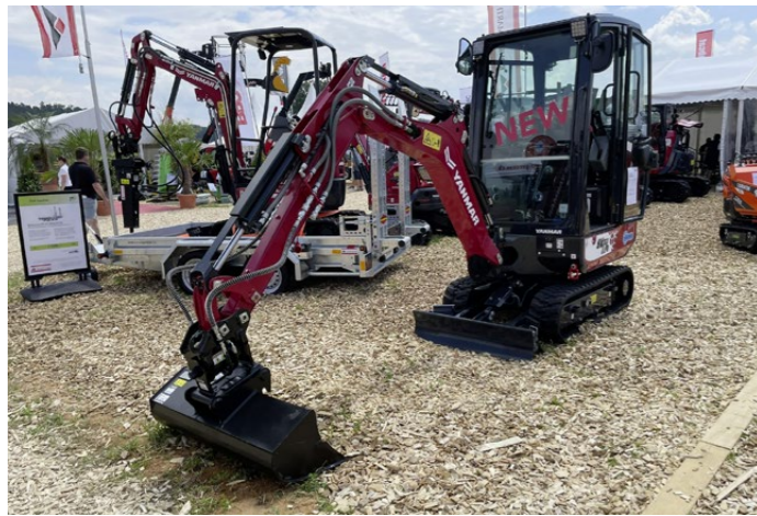
Abgasfreies Arbeiten: Yanmar bietet elektrische Radlader, Dumper und Bagger – hier der Minibagger «SV 17e» (1,9 Tonnen) am Stand von Rohrer-Marti.
