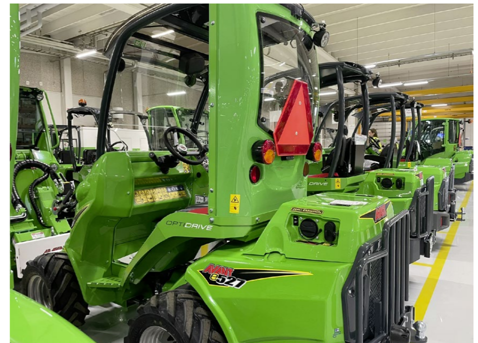
Nagelneue Elektrolader – hier das Modell «Avant e527» mit seiner 27 kWh grossen Batterie – warten im Auslieferungslager auf ihre Abholung.
