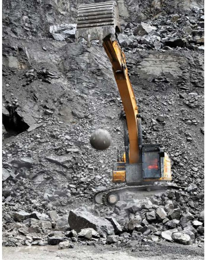
In die Schaufel geschweisste Schienen ermöglichen ein präzises Fallenlassen über dem Steinbrocken. Die 1,2 Tonne schwere Kugel fällt, ...
