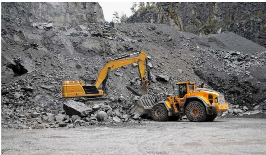
Schotterabbau im Steinbruch Balmholz: Ist das Material genügend gebrochen, wird es per Radlader zum Brecher abtransportiert.
