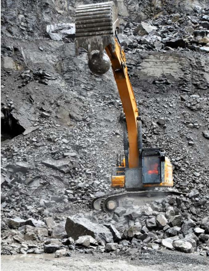
Das Spektakel in einer Art Zeitlupe: Auf eine Höhe von vier bis fünf Stockwerken hebt der «Cat 352» die Kugel und lässt sie fallen.
