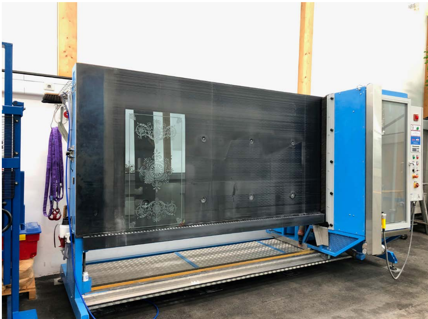
Mit der Satiniermaschine können verlaufende Satinierungen oder «Fade Out – Flächen», matte Oberflächen, die klar auslaufen, produziert werden.
