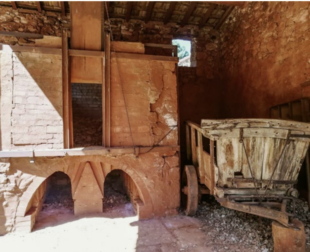
Damit der gelbe Ocker eine rote Färbung annahm, wurden die getrockneten Soden in den Ofen geschichtet. Für die Verfärbung brauchte es eine Temperatur von bis zu 450 Grad.
