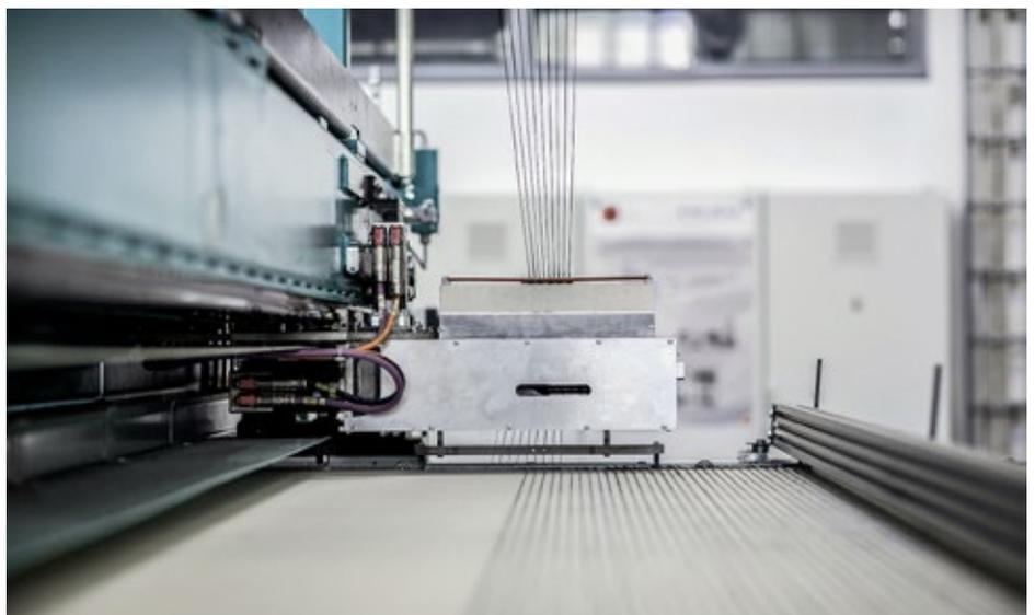
Auf der Textilmaschine entsteht Schritt für Schritt das Carbongelege, also die textile Bewehrung.
