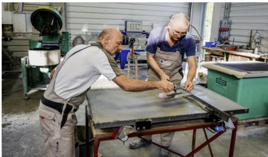
Auf dem in die erste Feinbetonschicht eingearbeiteten textilen Carbongelege wird die zweite Feinbetonschicht aufgetragen (oben). Nach dem Abziehen (unten) können bis zu drei weitere Textillagen folgen.
