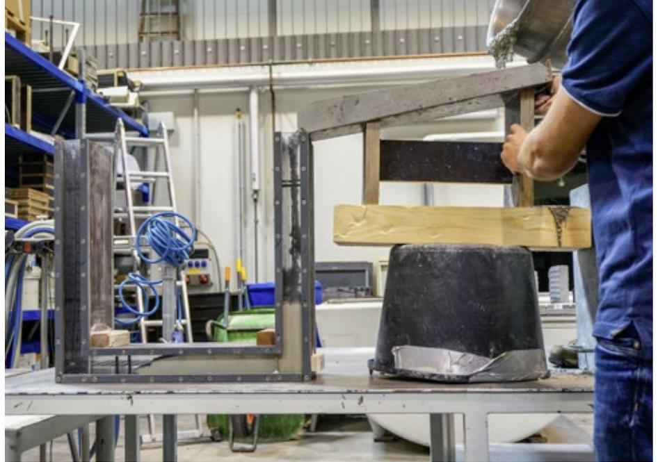
Auf der Suche nach dem idealen Feinbeton: Im Labor werden neue Rezepturen angerührt (links) und in Gussversuchen ausgetestet (rechts). Der Beton muss im Fluss bleiben – trotz der in die Form eingelegten, bremsenden textilen Bewehrung.
