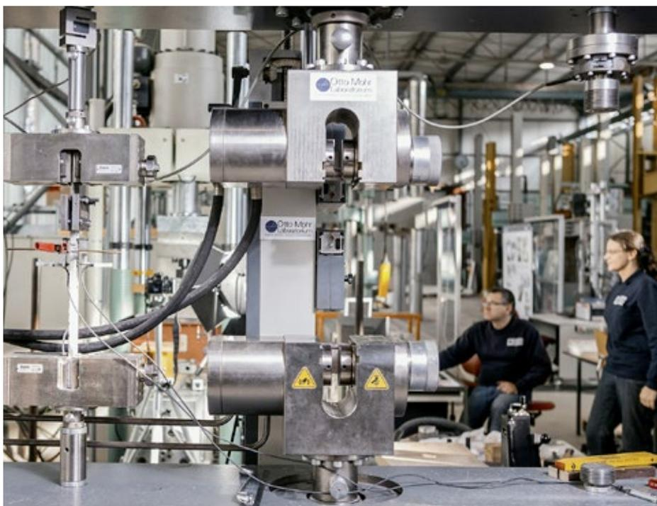
In der Prüfhalle des Dresdner Instituts für Massivbau läuft ein Test zur Ermittlung des Auszugswiderstands von Carbonbeton (oben). Sukzessive werden die Kräfte erhöht, bis der Probekörper reisst (rechts).
