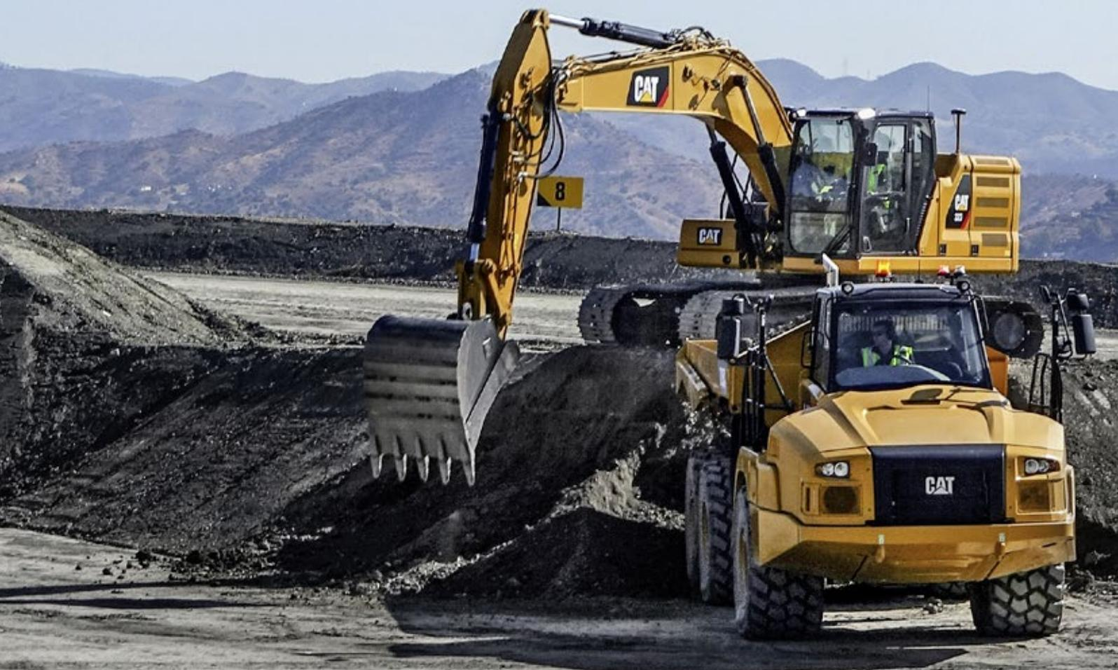
Der Cat 323 im Einsatz: Bei der Beladung wird automatisch mit dem Wägesystem «Cat Payload» das Gewicht jeder einzelnen Schaufelfüllung registriert, das Gesamtgewicht berechnet und so die Überladung des Transporters vermieden.
